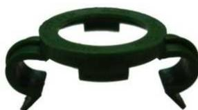
La bague d'identification à oreilles permet à la fois le marquage et l'identification de la douille de levage après coulage du béton, mais aussi de maintenir l'armature de renfort complémentaire en cas d'effort perpendiculaire.
