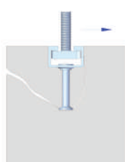
Rupture béton par effet de levier sous charge de cisaillement
