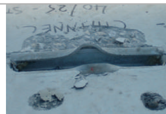
Rupture des lèvres du profilé sous charge de cisaillement
