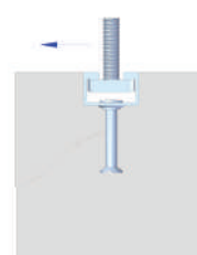
Rupture du bord béton sous charge de cisaillement
