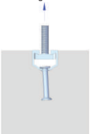
Rupture de la connexion profilé - patte sous charge de traction
