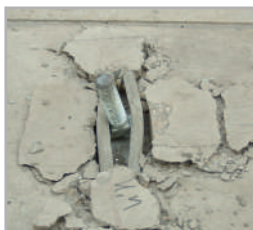
Rupture du boulon en T sous charge de cisaillement
