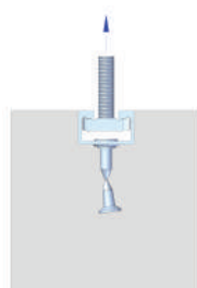
Rupture de la patte d'ancrage sous charge de traction
