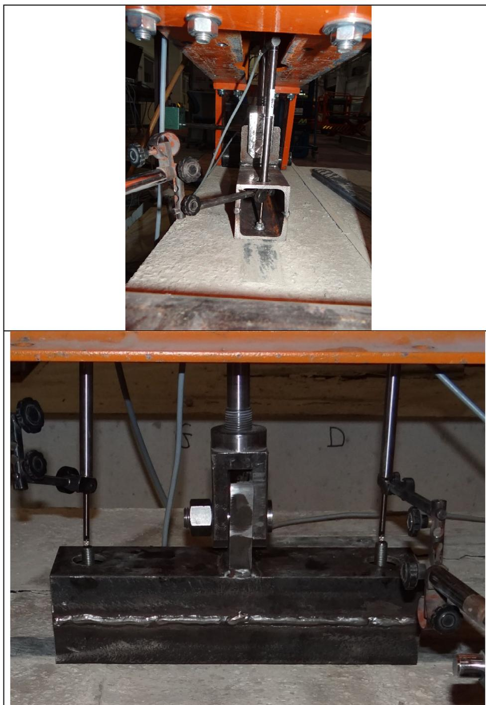
Figure 7 - Détails de l'assemblage et mise en place des capteurs de déplacement
