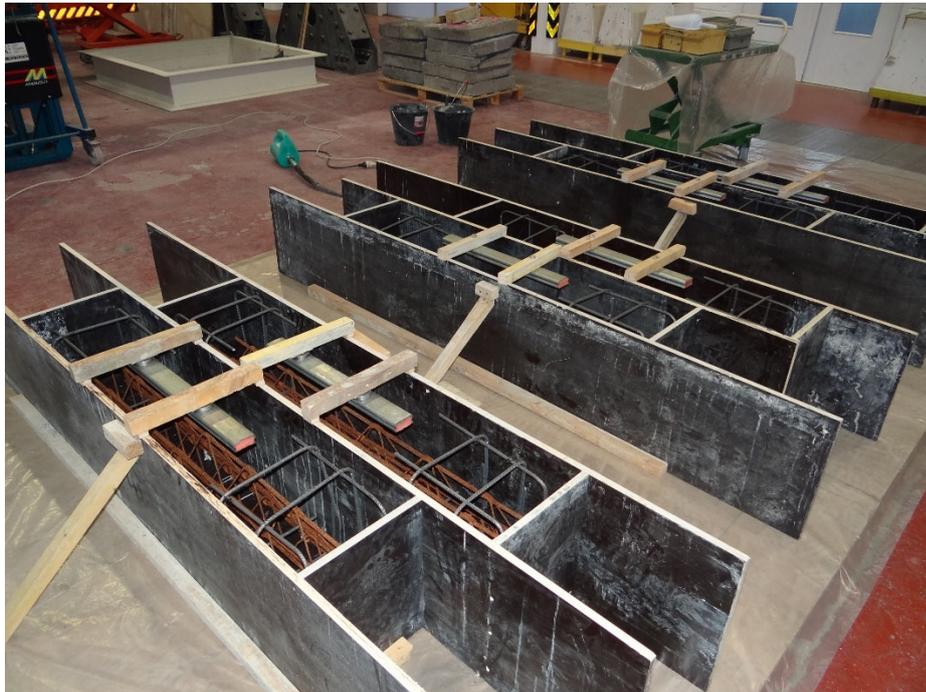
Figure 2 - Détails des corps d'épreuves avant coulage
