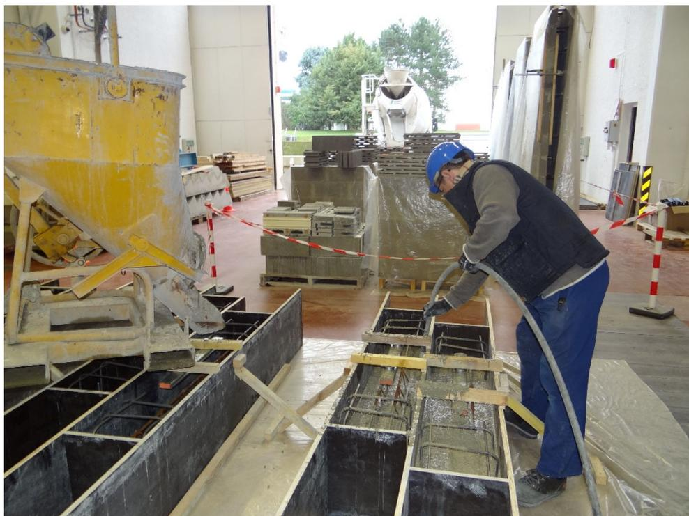
Figure 3 - Phase de coulage des corps d'épreuves avec une opération de vibration
