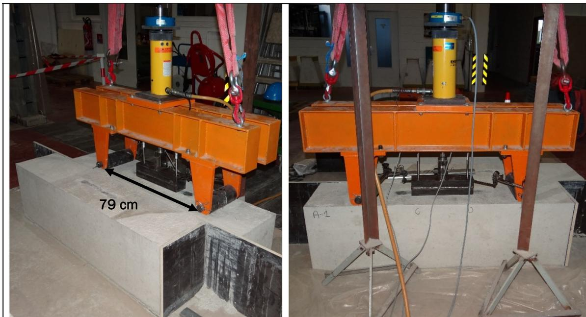
Figure 5 - Dispositif d'essai : Ecartement des appuis
