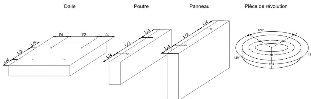
Pour les charges dissymétriques, les efforts de traction doivent être calculés pour chaque point de levage en fonction de sa distance au centre de gravité.
