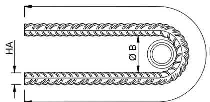
Distance minimale aux bords et entre les douilles et épaisseur mini
