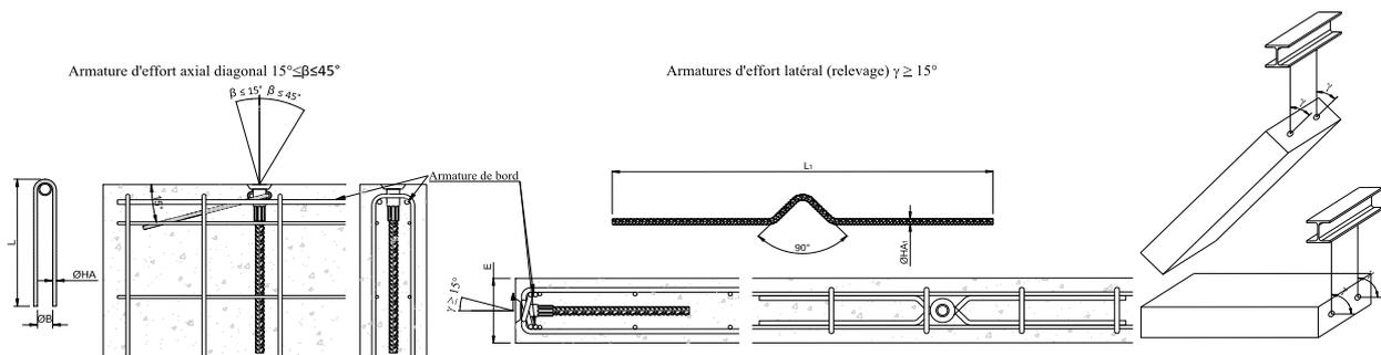
Distance minimale aux bords et entre les douilles et épaisseur mini : La capacité de charge en kN varie en fonction de l'épaisseur de l'élément et de la résistance à la compression du béton  $f_{ck}$ , ainsi que des distances minimales à respecter entre les douilles et par rapport aux bords de l'élément.
