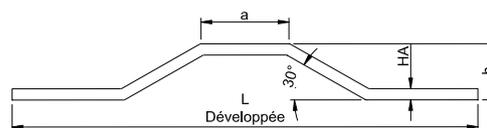
En cas d'effort axial diagonal  $10^\circ \leq \beta \leq 45^\circ$ , un étrier supplémentaire doit être mis en place
