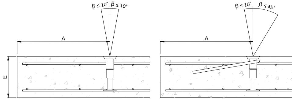
La résistance de la douille à l'arrachement dépend de la profondeur de la douille dans le béton, de la résistance du béton et des distances par rapport au bord.
