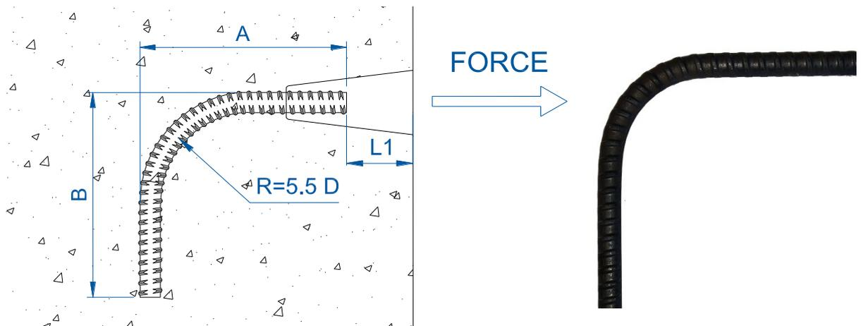
La valeur de charge en traction reprise par une tige coudée dépend du diamètre de la tige, des dimensions A et B (en respectant bien le sens de pose) et de la résistance du béton.
