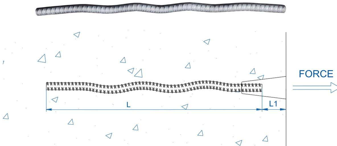
La valeur de charge en traction reprise par une tige ondulée dépend du diamètre de la tige, de sa longueur et de la résistance du béton.
